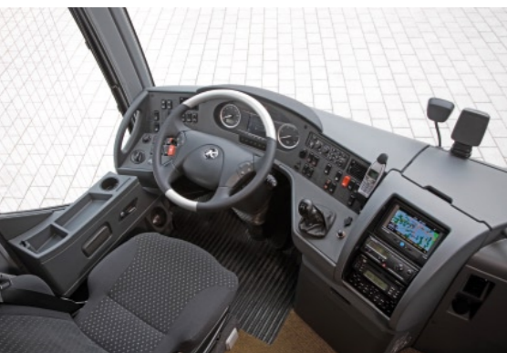
So wünscht man sich das: lederbezogenes Multifunktionslenkrad, übersichtliche Anordnung sämtlicher Bedienelemente, Joystick für die Bedienung des PowerShift-Getriebes sowie ein gut lesbares Kombiinstrument
