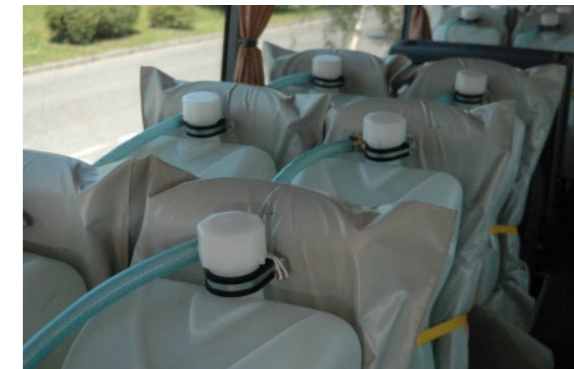
Fahrgastsimulation: Selbstverständlich sind unsere Testfahrzeuge ballastiert
