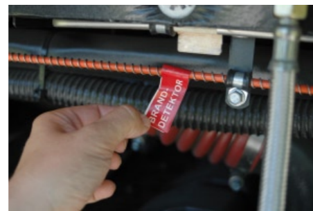
Interessantes Sicherheitsfeature: eine integrierte Feuerlöschanlage soll etwaige Brände im Motorraum schon im Ansatz ersticken
