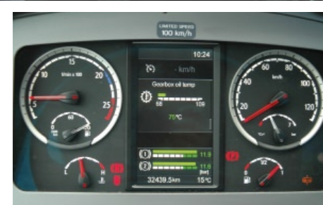
Der Arbeitsplatz glänzt durch tadellose Übersichtlichkeit, vor allem die neu gestaltete Instrumenteneinheit mit einem 6,5 Inch TFT-Display ist perfekt ablesbar
