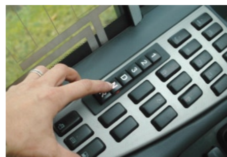
Die ZF-Automatik wird mittels Drucktasten bedient
