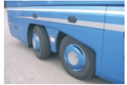
Die Nachlaufachse lenkt elektrohydraulisch mit.
