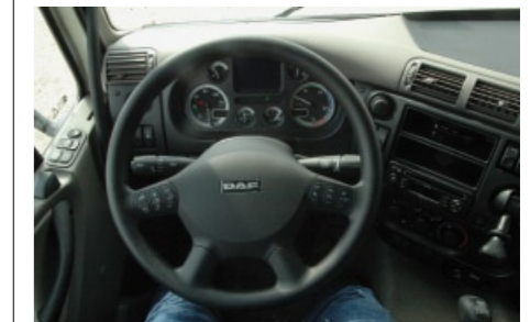
Die Flüssigkristall-Anzeige informiert den Lenker über die Fahrdauer, den Kraftstoffverbrauch, die Durchschnittsgeschwindigkeit und die Betriebsstunden des Nebenantriebs
