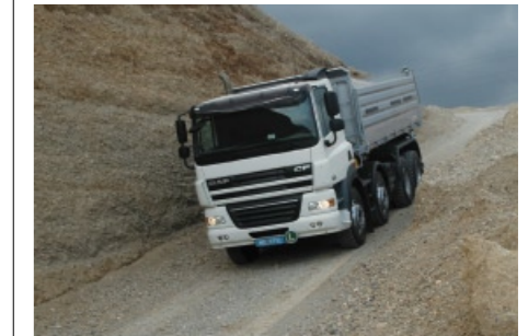
Die DAF Engine Brake sorgt bergab, auch ohne Retarder, für eine ordentliche Verzögerung
