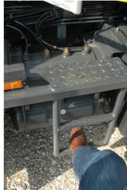
Geschickt vom Aufbau integrierte Auftritte ermöglichen einen Kontrollblick auf die Ladung
