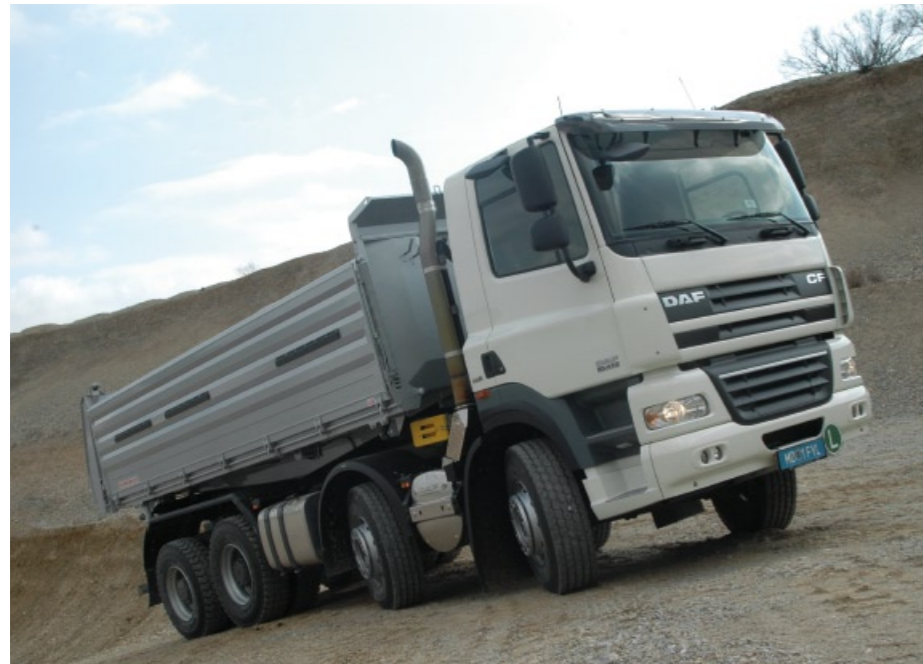
Paccar spendierte dem CF85 den völlig neuen 12,9 Liter MX-Motor aus dem neuen XF105
