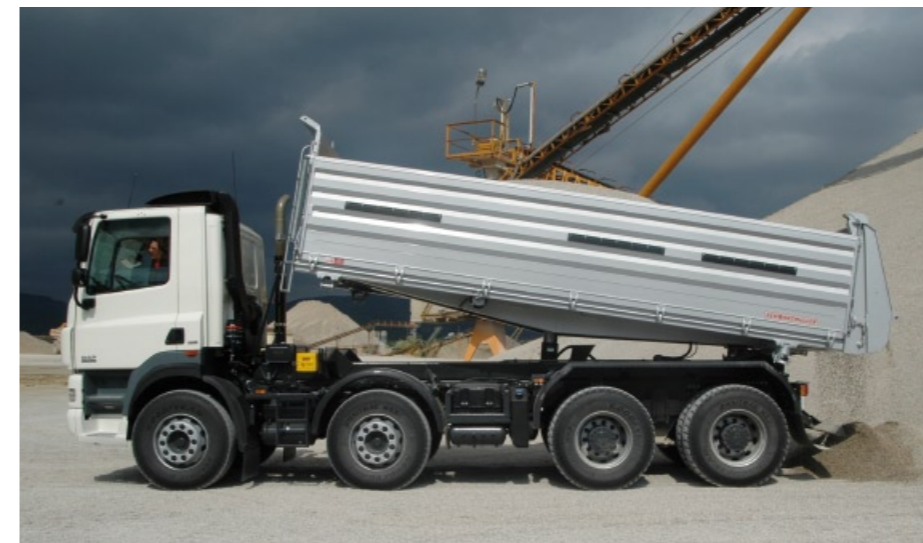
Der AdBlue-Tank sitzt geschützt zwischen den Achsen, leider nicht auf der gleichen Seite wie der Diesel-Tank. Deutlich zu erkennen sind die Außenplaneten-Achsen
